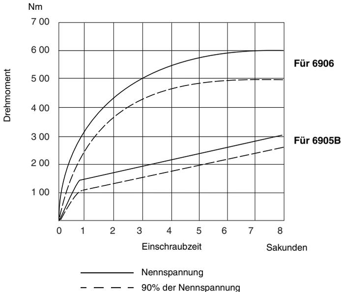
Halten Sie die Maschine fest und setzen Sie den Steckschlüsseinsatz auf die Schraube oder Mutter. Ziehen Sie unter Berücksichtigung der Einschraubzeit die Schraubverbindung an.
